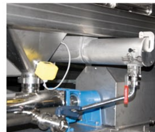
La tramoggia di estrazione prodotto, collegata a un'elettropompa monovite (accessorio), e la coclea per l'evacuazione degli scarti
