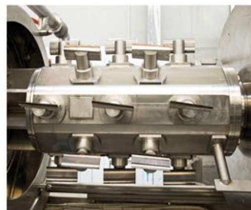
Il rotore a pale regolabili, completo di unità di triturazione, in posizione di macchina aperta
