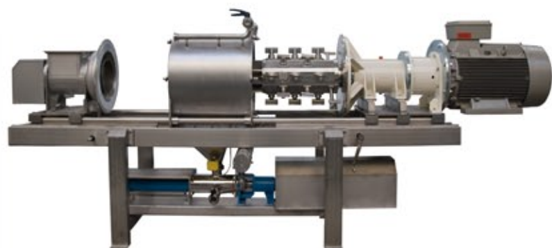
Vista laterale del gruppo di estrazione Mod. PR411/2A "aperto", per le operazioni di ispezione e pulizia
